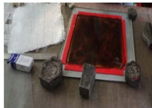
(d) Laying of Jute mat with epoxy resin
