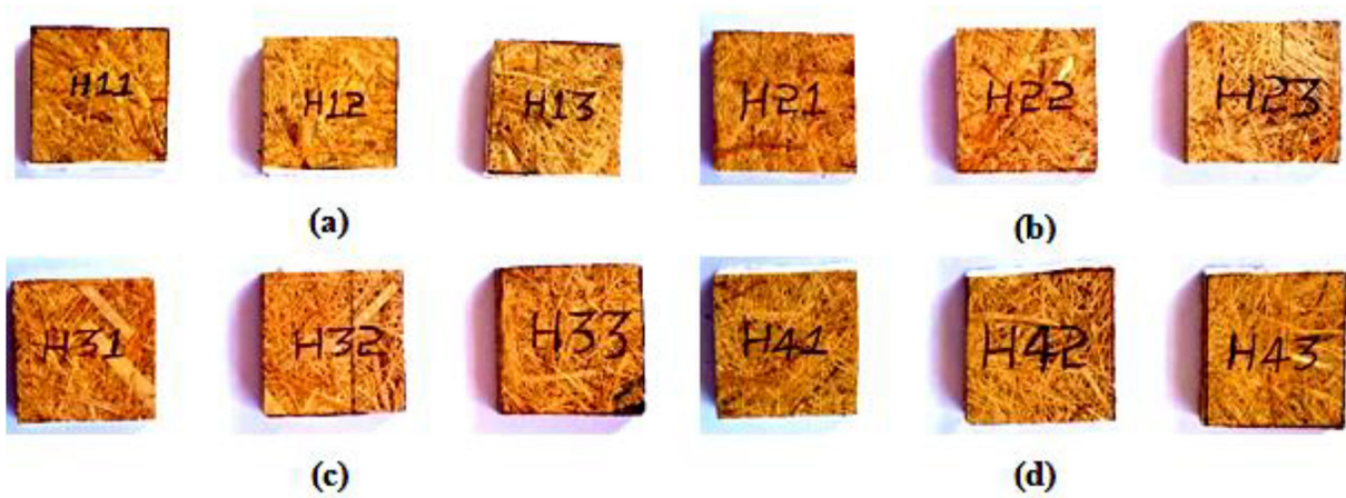
Fig. 2. Rockwell hardness test specimens of (a) C1 composites (b) C2 composites (c) C3 composites (d) C4 composites.
